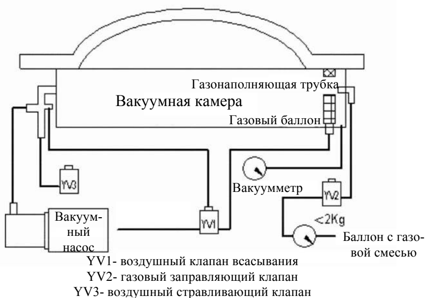
Схема вакуумного упаковщика с системой газации
